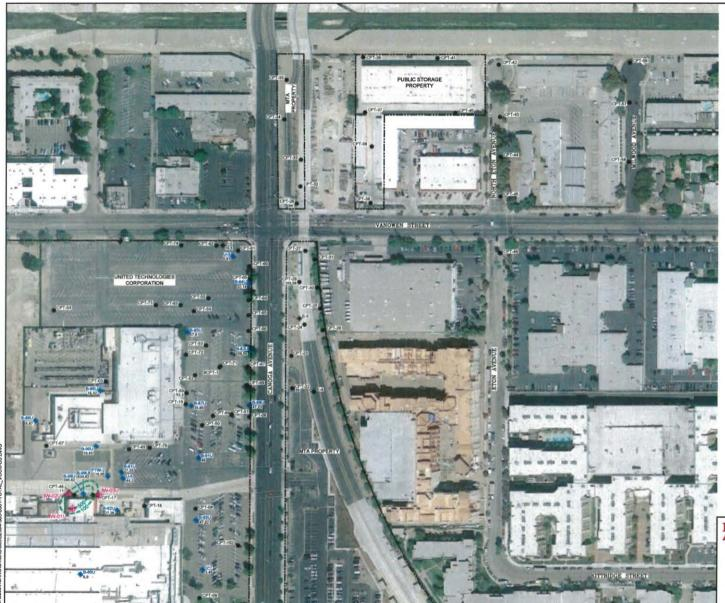
LEGEND: APPROXIMATE PROPERTY LINE FENCE MONITORING WELL LOCATION U - UPPER SAND ZONE I - INTERMEDIATE SAND ZONE D - DEEP SAND ZONE FORMER EXTRACTION WELL LOCATION
