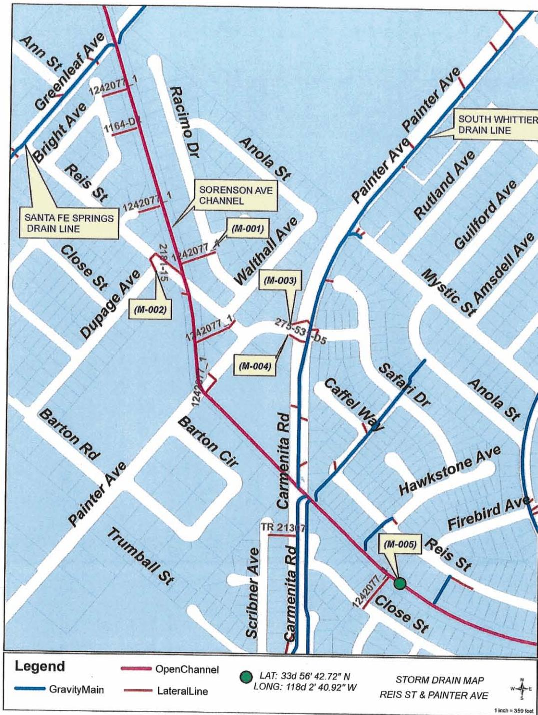
Figure 2. Storm drain map (Discharge Points M-001 – M-005)
