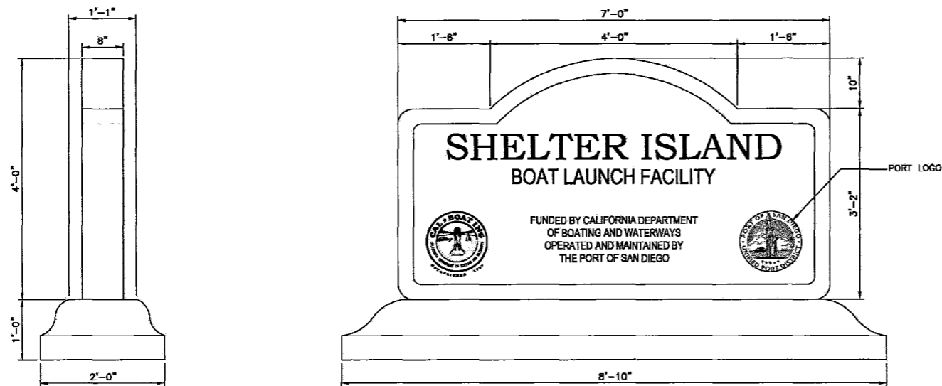
1 CONCRETE PROJECT SIGN CS-101 CS-506 SCALE: 1" = 1'-0"
