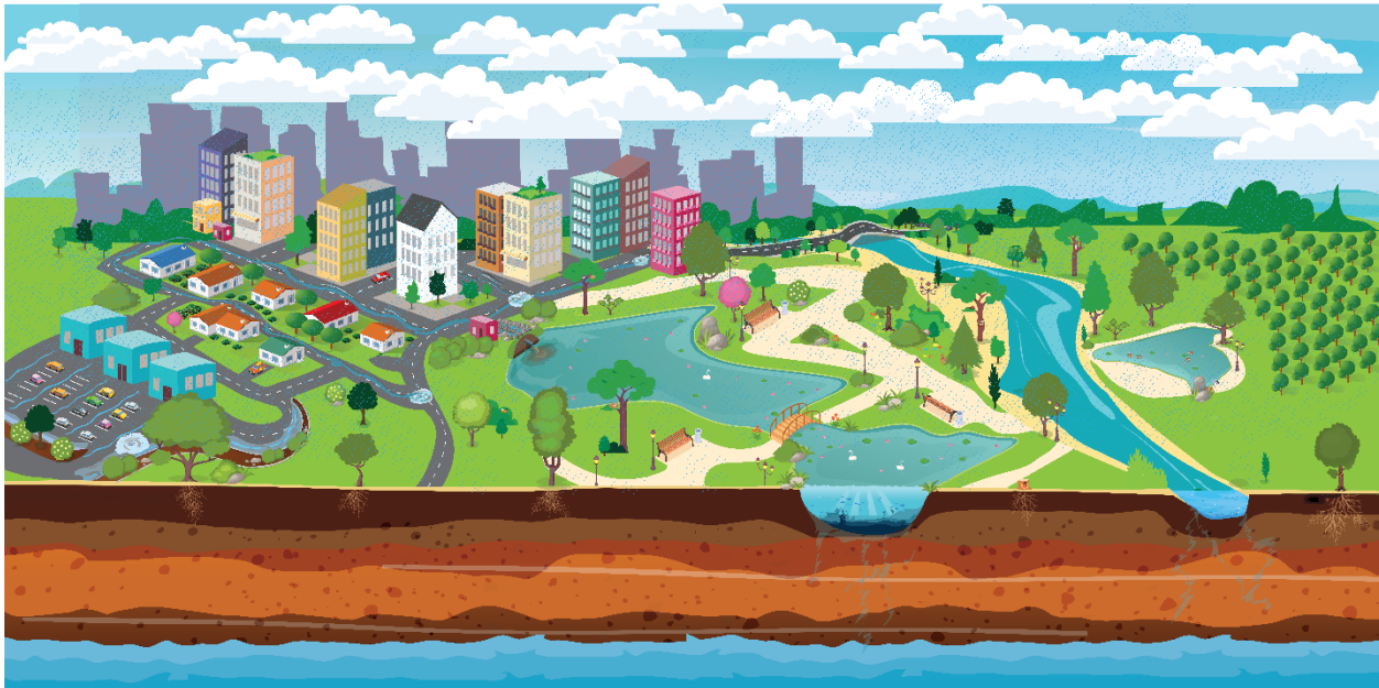
Figura 1: La lluvia corre por las calles de la ciudad hasta un desagüe pluvial, que desagua en un estanque cercano. El estanque sirve de hábitat para la fauna local y permite que las aguas pluviales se infiltren en el suelo y recarguen las aguas subterráneas.
