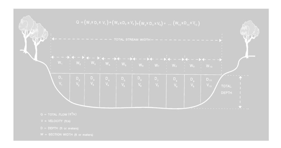
Figure 2. Stream Flow (Discharge) Measurement
